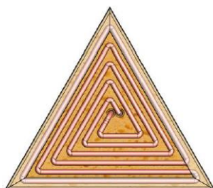
Figura 8: Arranjo dos tubos internos de coletor triangular proposto para uso em fachadas [15].
