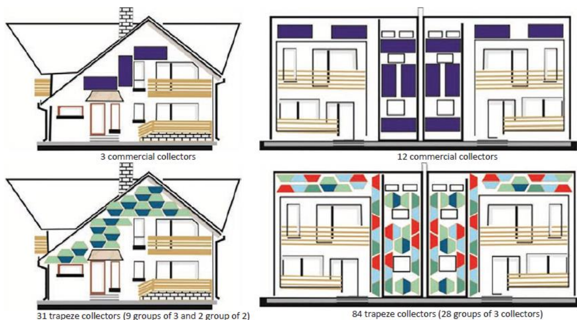
Figura 9: Exemplos de fachadas térmicas, comparando o uso de coletores retangulares tradicionais com os coletores de formato trapezoidal sugeridos [16].
